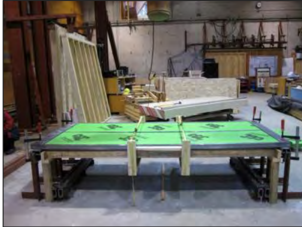
g) Two 24” wide panels and stud frame
