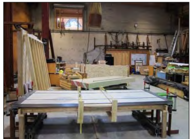
f) 1/2" Type C gypsum wallboard and stud frame
